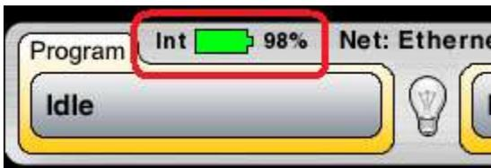
Este icono indica que la alimentación proviene de la batería y que el alimentador externo no está conectado al equipo.
