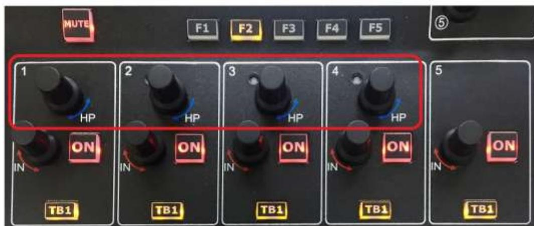
En la imagen se muestran los controles de ganancia de auriculares. Cualquier cambio en un potenciómetro hace surgir una ventana en la pantalla con la indicación de dB. Un *LED verde* indica que los cambios de los siguientes controles afectan solo a *esa* salida de auriculares.
