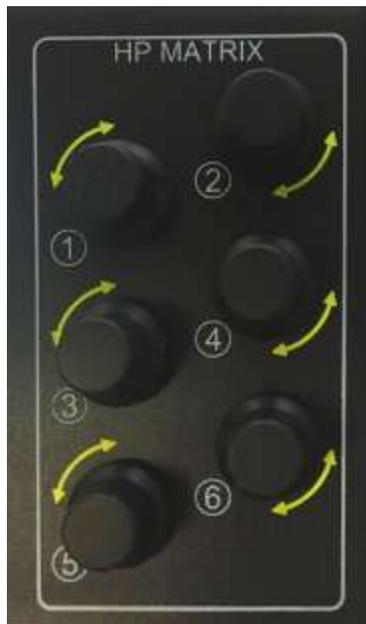
Tras la selección del botón de ganancia de auriculares, (basta con presionar o girar los potenciómetros HP 1...4), el usuario accede a la mezcla de señal de cascos, disponible en los potenciómetros etiquetados como **HP MATRIX** en la parte derecha del equipo.
