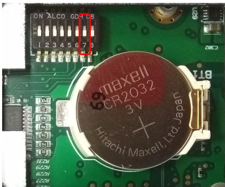
**Imagen 12. Microinterruptores y pila en Quantum MC.**
